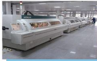
机械钻孔机 Mechanical drilling (Hitachi)
